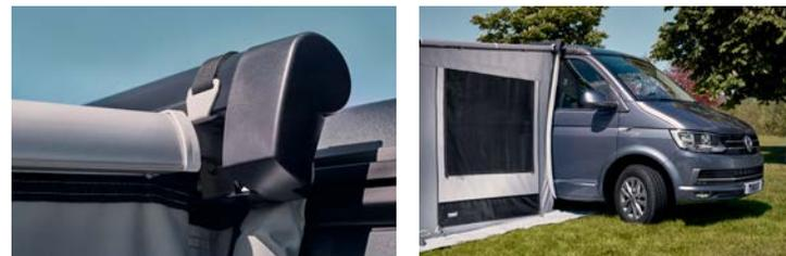
Une bande mousse avec sangle garantit une étanchéité complète avec la paroi du véhicule pour éviter l'entrée du vent.
