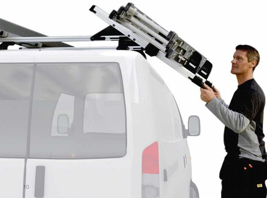
Fonction d'enlèvement intelligente le système de basculement pour échelle Thule 311 peut être enlevé du toit et basculé sur le côté du véhicule afin de vous offrir une hauteur de chargement confortable. Une fois les échelles chargées et sécurisées, refaites simplement glisser le porte-échelle sur le toit.
