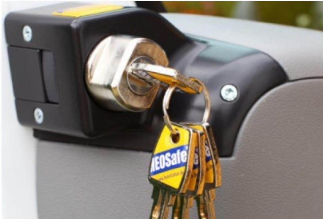
Idéal lors des stationnements, ce système protège votre véhicule des voleurs en verrouillant les portières avant.
