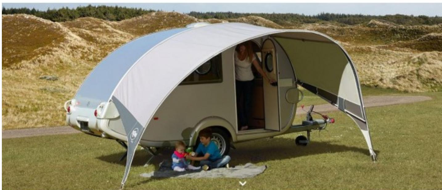
Matière face avant en acrylique (isacryl). Panneaux de côté et toit en polyester enduit, panneau inférieur en pvc. Détails l'avant est amovible et rabattable.
